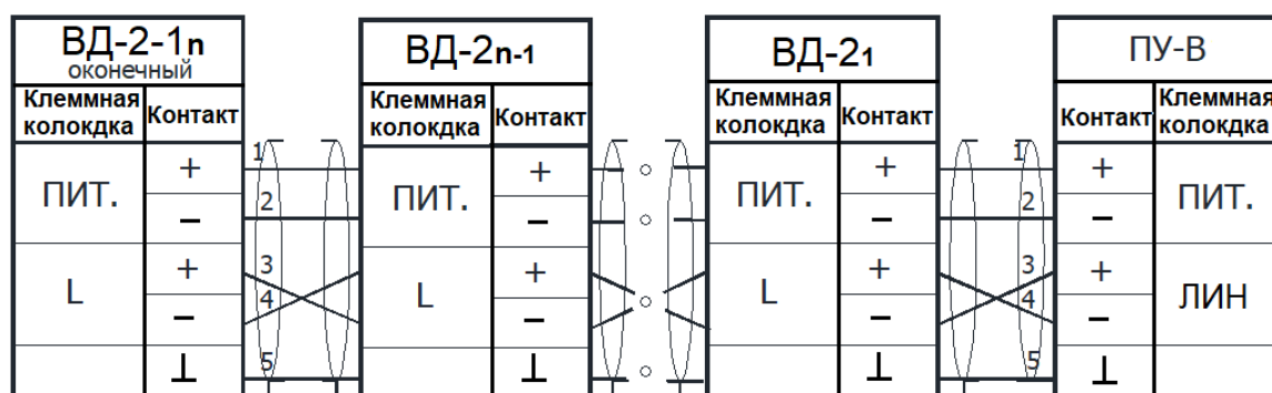
Рисунок 2 - Схема соединения ВД-2 с ПУ-В и с ВД-2-1
